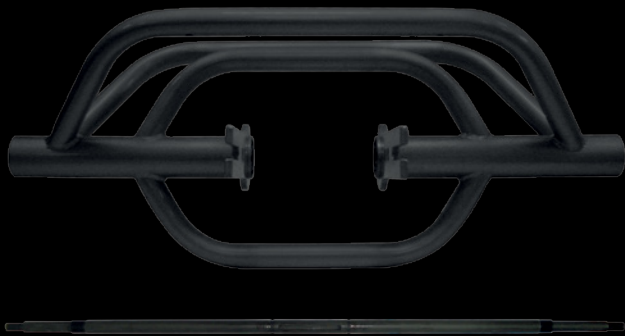
TRICICLO FORMADO POR 2 ESTRUCTURAS ENCAJADAS ENTRE SI, ESTE SISTEMA EVITA QUE EL TRICICLO SE DESPLAZE HACIA EL LADO CONTRARIO AL QUE EFECTUAMOS EL GIRO
